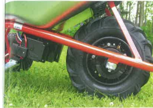
➤ Mobarrown akku on suojassa koteloituna kupan alla. Moottori ja voimansiirtopaketti on rakennettu pyörän napaan.
